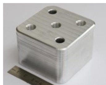
Abb. 8: Das geschweißte Bauteil nach dem groben Zerspanen.
