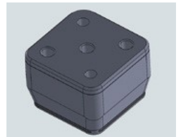
Abb.1: Das CAD-Modell des Bauteils mit einer Seitenlänge von 55 mm.
