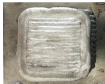
Abb. 7: Das fertig geschweißte Bauteil vor der Nachbearbeitung.
