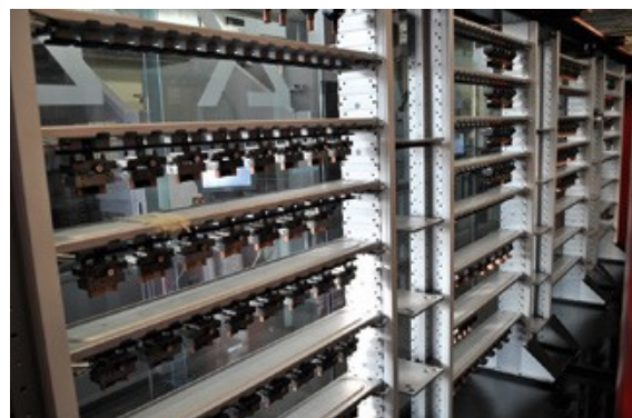
Werkstück- und Elektrodenmagazin der Erodieranlage. Bild: Glatzer
